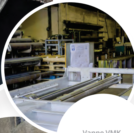
Vanne VMK sur mesure avec vérin inox intégré
