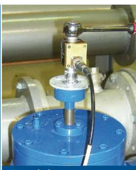
Un couple de manœuvre très faible quelque soit le différentiel de pression Amont-Aval
